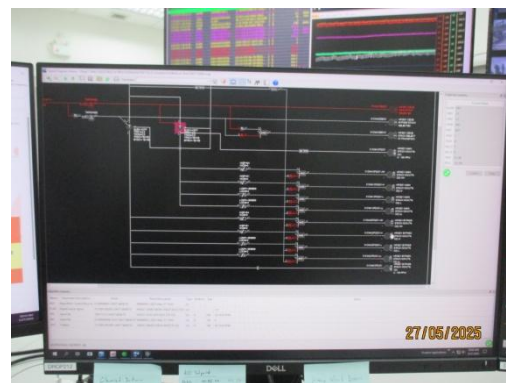
รูปที่ 3-4 หน้าจอ DCS แสดงระบบหัวฉีดเผาไหม้ แบบ Dry Low \text{NO}_x
